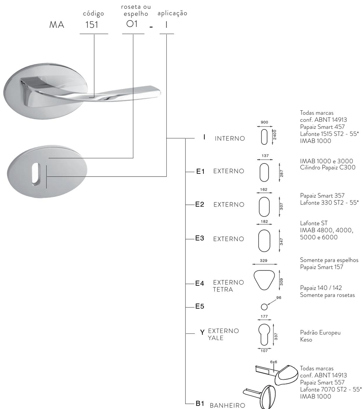
Dimensões conf. padrão ABNT. Fechaduras diferentes, contate-nos.
